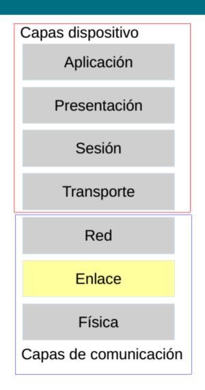
La capa de Enlace se le asigna el protocolo físico correcto a las datos. En esta capa se define el tipo de red y el manejo de la secuencia de los datos.
