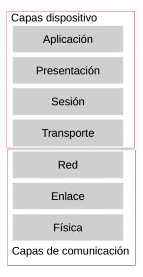
• El modelo OSI nos permite entender los procesos internos que ocurren dentro de un dispositivo (computadora, tablet, o teléfono inteligente) que le permiten enviar y recibir mensajes.
