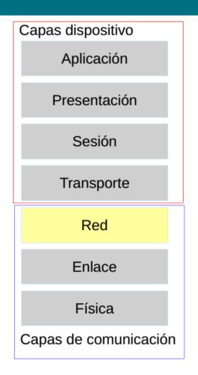
La capa de Red es la encargada de manejar y procesar todo el direccionamiento de los datos que recibe. En otras palabras, en esta capa es que se determina desde donde y hacia donde van los datos.
