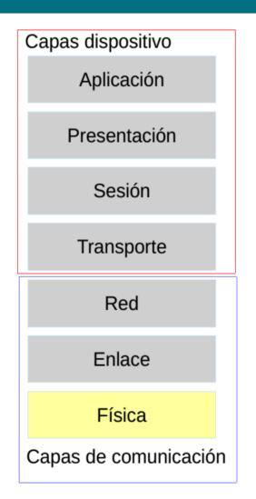
Esta es la capa que se encarga de transmitir los datos por medio de la conexión física Esta conexión puede ser fibra óptica, microondas, cobre o cualquier medio con capacidad de transmitir datos de una forma u otra (señales, niveles de voltaje, etc).
