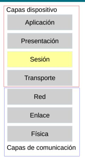
La capa de Sesión se encarga de iniciar y terminar las comunicaciones entre dos dispositivos. Provee mecanismos de seguridad que permiten al proceso continuar o ser finalizado. Valida que en efecto el dispositivo este autorizado para la comunicación
