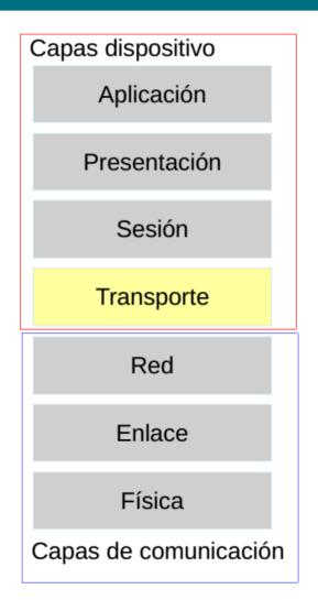
La capa de Transporte controla el flujo de los datos y provee mecanismos para la detección y corrección de errores. Debido a que esta capa recibe contenido de diferentes aplicaciones, esta se encarga de colocar el contenido en los espacios para la aplicación correcta.
